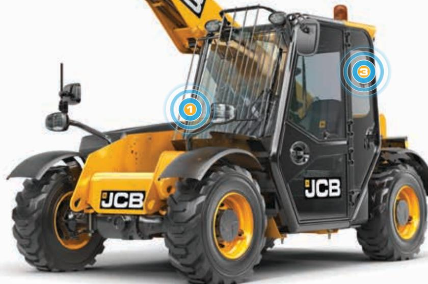
**6** El control de la JCB 525-60 Hi Viz resulta cómodo, preciso y suave: está equipada con mandos servo eléctricos de una sola palanca y controles auxiliares proporcionales.
