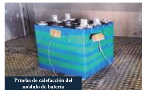
Prueba de calefacción del módulo de batería
