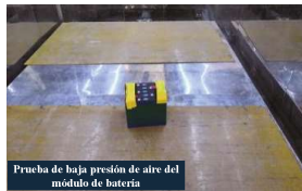
Prueba de baja presión de aire del módulo de batería
