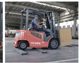
Prueba de refuerzo Refuerzo de todo el vehículo durante 800 horas (incluye subir cuevas, enfrentar lluvia, superficies irregulares, etc.).
