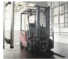
Prueba de lluvia Simula el funcionamiento bajo una tormenta de lluvia de 15 minutos para alcanzar el nivel de protección IPX4 y cumplir los requisitos de funcionamiento en exteriores.
