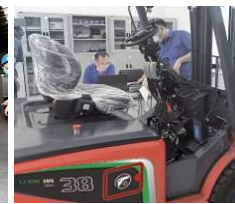
Prueba de vibración de todo el vehículo Realiza la prueba de frecuencia de vibración de toda la máquina para optimizar y mejorar la comodidad de funcionamiento.
