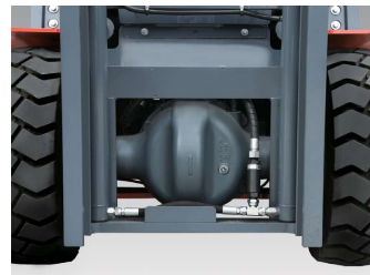
Eje motriz: Tambor de freno integral, carcasa del eje de fundición integral, diseño de sello de aceite de semieje, engranaje de coincidencia grande de alta precisión
